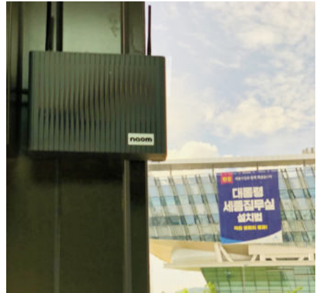
그림 8. 준실외공간인 버스정류장에 설치된 미세먼지 저감장치와 공기질 정보 수집장치 활용 스마트 제어 사례 - 세종시 BRT정류장
